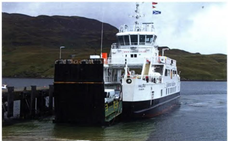
Anlegen mal anders: Die HALLAIG klammert sich zum Festmachen mit der Rampe auf den Slipway. Daraufhin wird der vordere Teil heruntergeklappt und das Schiff liegt fest. Foto: Torsten Noelting
