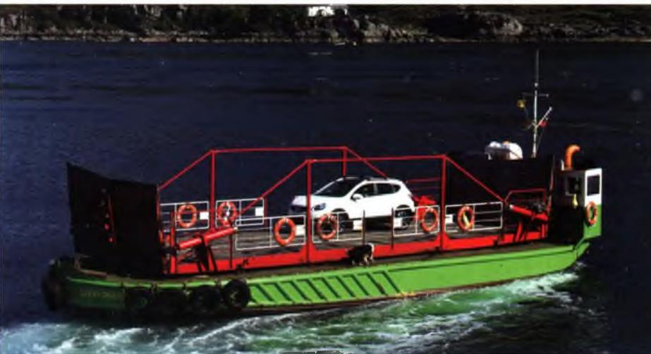
Die GLENACHULISH am Slipway von Kylerhea. Auf den obigen Fotos ist das Prinzip der „Turntable-Ferry“ (Drehteller-Fähre) gut zu erkennen: 1. Auffahren, 2. Das Fahrzeugdeck wird durch die Crew gedreht, 3. Überfahrt nach Glenelg: die GLENACHULISH in Fahrt. Fotos Torsten Noelting
