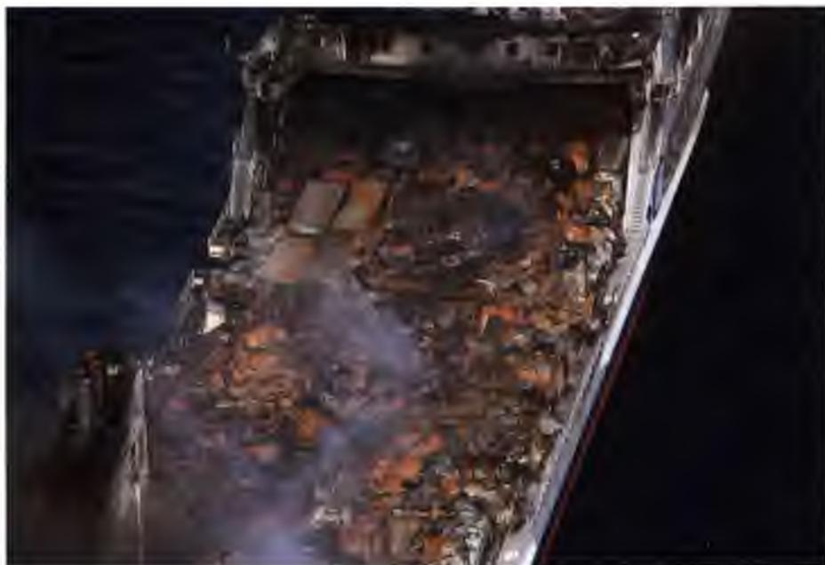
Diese Aufnahme entstand zwei Tage nach dem Brand. Deutlich ist die vernichtende Wirkung des Feuers auf dem Freideck der LISCO GLORIA zu sehen. Einzelne LKW sind noch zu erkennen, der Rest ist mehr oder weniger verschmolzen. Foto: Carl Groll
