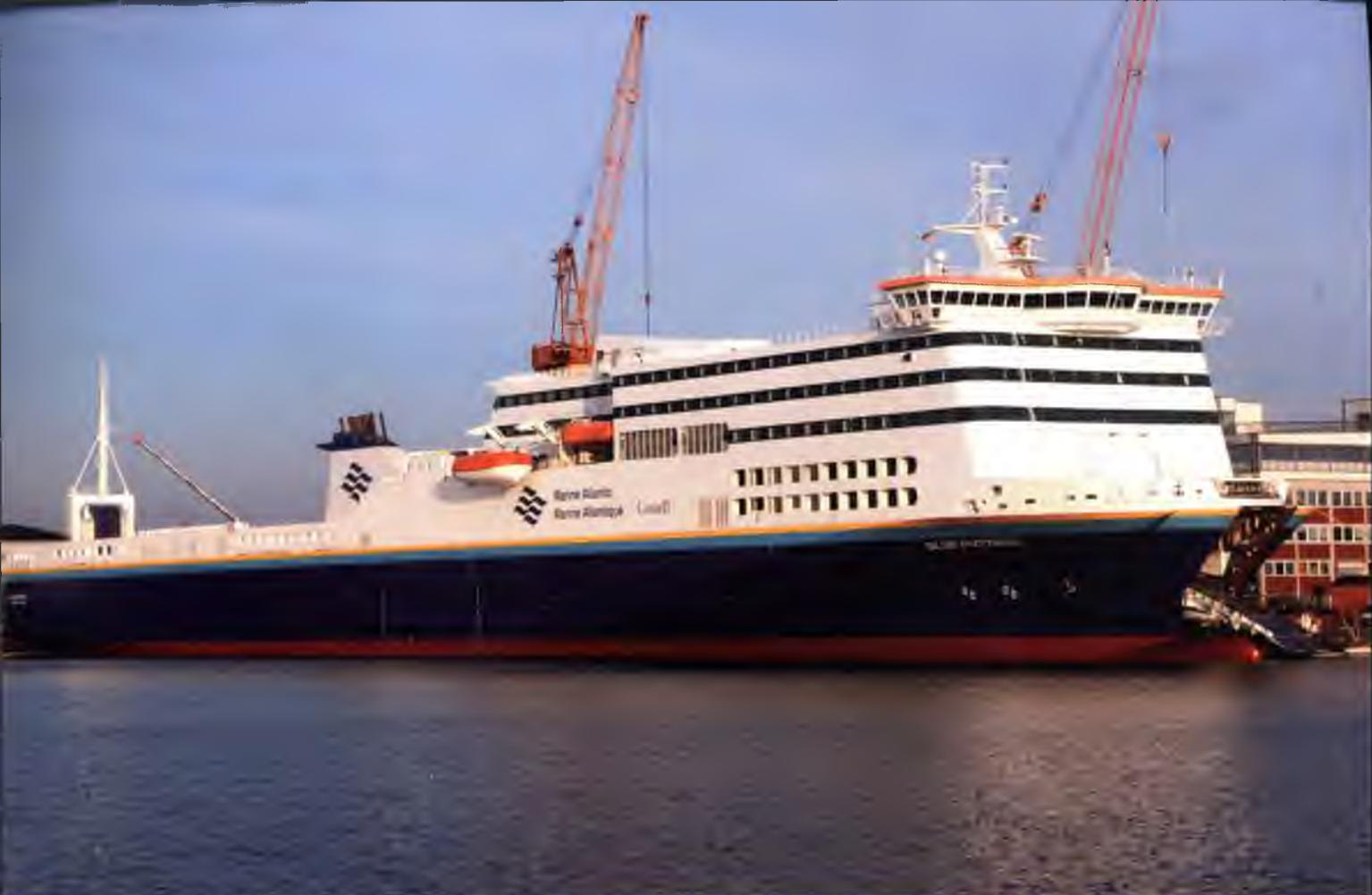
*Die BLUE PUTTEES ex STENA TRADER am 28. November 2010 bei der Lloyd Werft in Bremerhaven. Das Schiff wurde hier um 12 m verkürzt, ein Bugtor eingebaut und die Passagierunterkünfte erheblich erweitert. Ab dem Frühjahr 2011 soll sie von North Sydney zur kanadischen Insel Neufundland fahren. Der Umbau der STENA TRAVELLER zur HIGHLANDERS begann im Dezember.*
