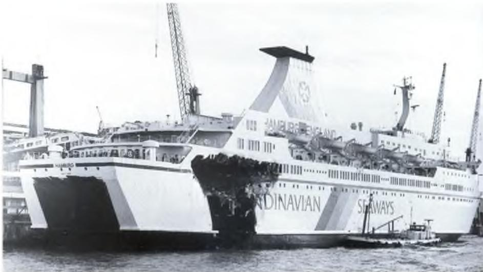
**Die HAMBURG nach der Kollision mit der NORDIC STREAM an der Columbuskaje in Bremerhaven. Foto: Gerhard Fiebiger**
