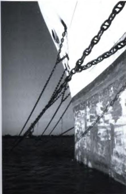
Um die Schiffe auf Strand zu ziehen, werden Löcher in den Rumpf geschnitten. Durch diese wird dann die Ankerkette gezogen und auf diese Weise geht es langsam Richtung Land.
