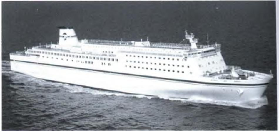
Seit dem 9. Januar 2005 verkehrt die wohl luxuriöseste Fähre Japans, die KISO, für Taiheiyo Ferry zwischen Nagoya, Sendai und Tomakomai. Das Schiff ist mit 15.795 BRT vermessen, 199,9 m lang und kann 800 Passagiere in Kabinen befördern. Für Fracht stehen auf 3 Decks 2.239 Spurmeter zur Verfügung. Foto: Archiv Frank Lose
