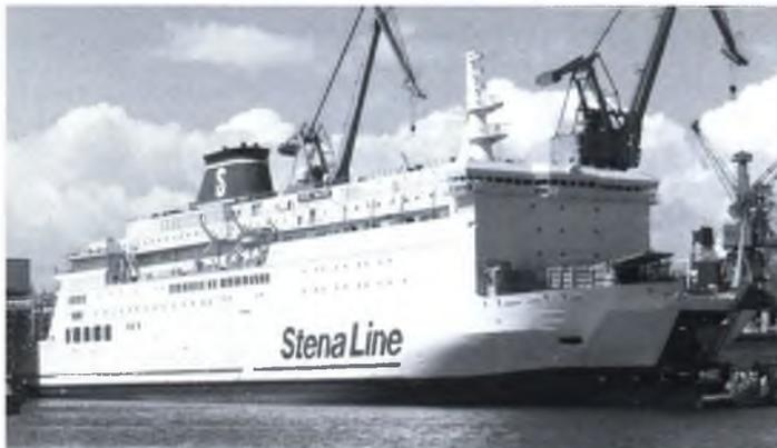
Die STENA BALTICA am 16. April im Dock bei Remontowa in Gdansk. Erkennbar ist die obere Zufahrt zum neuen zweiten Lkw-Deck, außerdem fehlen im vorderen Bereich des Schiffes zwei Kabinendecks, die nun für Fracht genutzt werden. Foto: Jakub Bogucki
