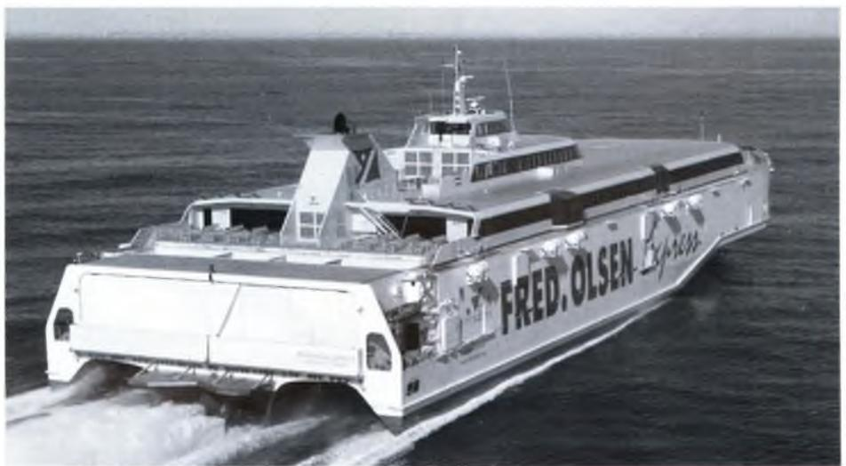
**Die mit drei Rümpfen versehene neue BENCHIJIGUA EXPRESS ist 126,7 m lang und damit genau 10 cm länger als die HSS-Schiffe von Stena. Foto: Austal Ships**
