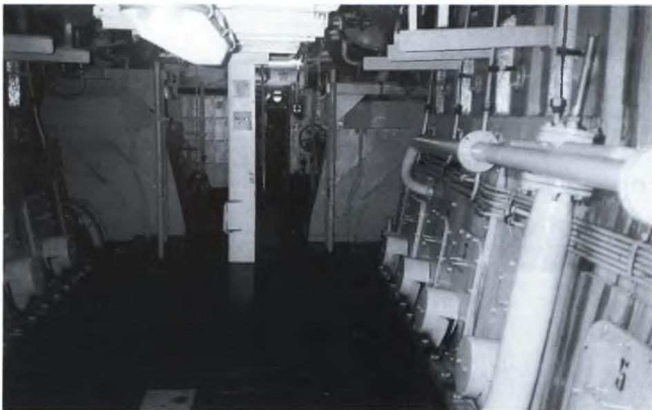
Der Hauptmaschinenraum befindet sich in gutem Zustand. Zu sehen sind Hauptmotor 2 und 3 sowie die Induktionskupplungen. Foto: Dirk Stachely
