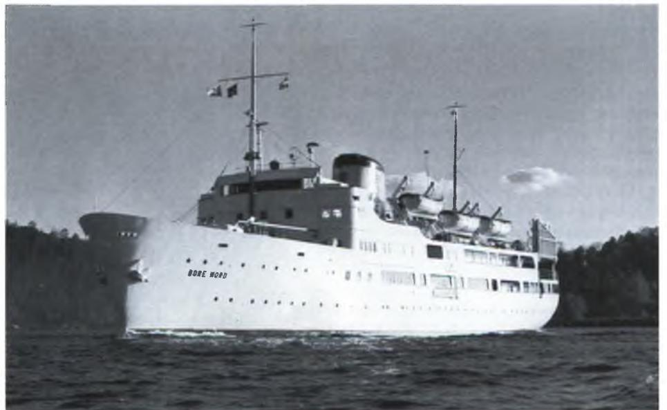
Die BORE NORD im Einsatz für Jakob Lines. Deutlich ist am Heck die Seitenklappe, die als Zufahrt für das PKW-Deck dient, zu erkennen. Foto: Archiv Frank Heine
