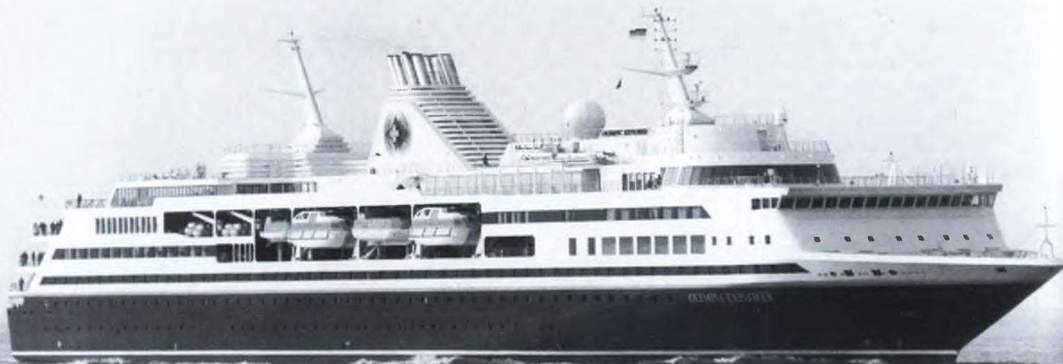
Alsthom / 13 500 kW / 2 Schrauben / 18 kn
