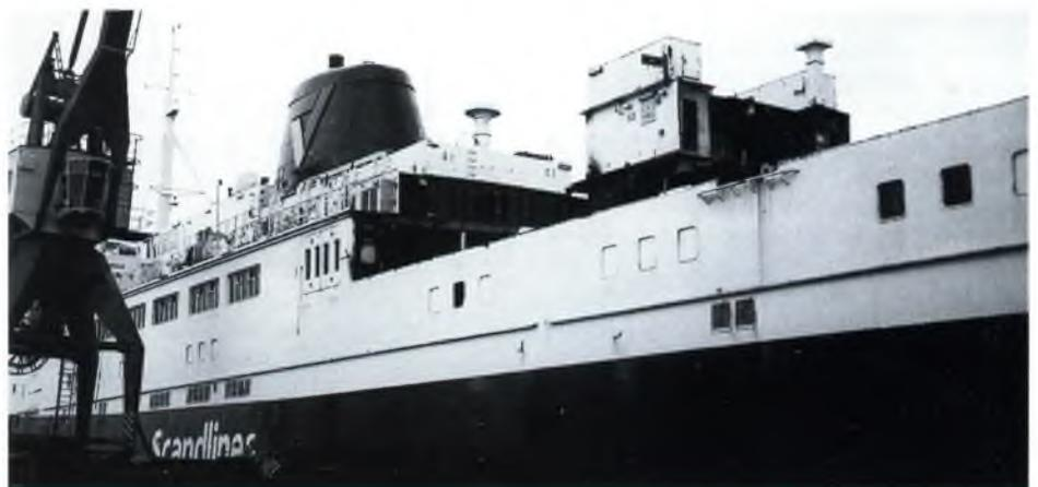
**Bis hinter den Schornstein sind die oberen Decks im Dezember 1999 bereits abgebrochen. Links ein Schwimmkran, der die Arbeiten unterstützt. Foto: Carsten Watsack**
