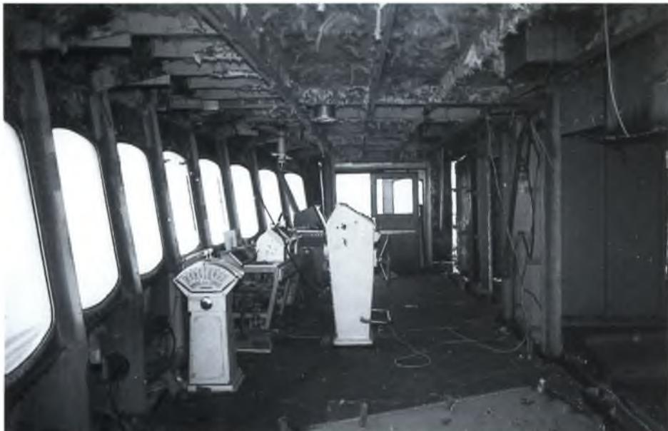
Die einst mit Holz verkleidete Inneneinrichtung der Brücke ist nur noch ein Schatten ihrer selbst. Übrig blieb der Fahrstand, ein altes Radargerät sowie der von 1968 stammende Maschinentelegraf. Foto: Jan Vinther Christensen
