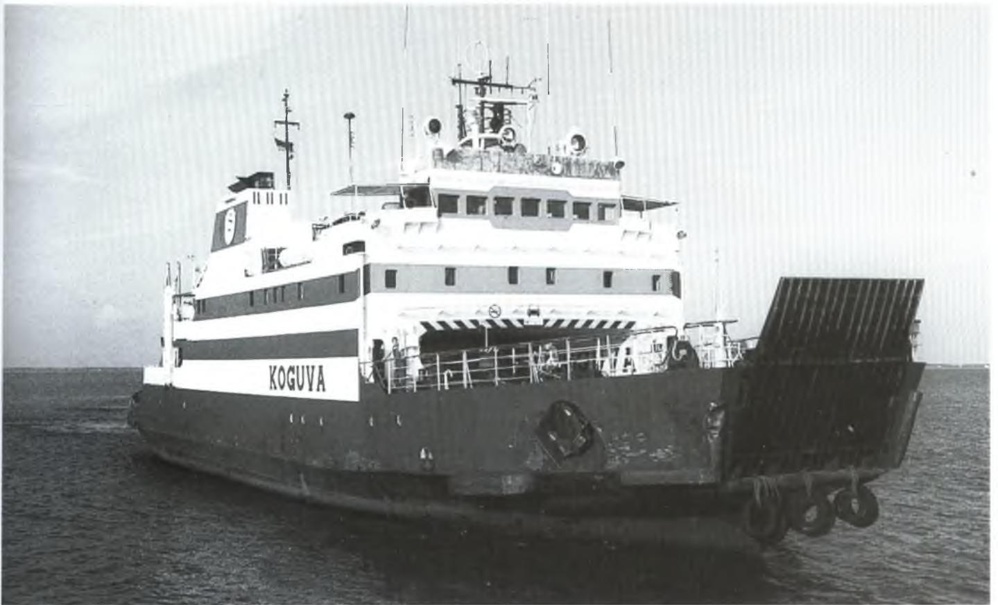
Älteste der Serie von eisbrechenden Fähren mit dieselektrischem Antrieb (!) ist heute die KOGUVA, 1979 in Riga gebaut. Bei ihr wurde noch in ESCO-Zeiten versucht, ihr ein moderneres Outfit zu verpassen (blauer Rumpf und blaue Streifen an den Aufbauten). Alle anderen Fähren dieses Typs haben einen schwarzen Rumpf und weiße Aufbauten. Foto: Marko Stampehl
