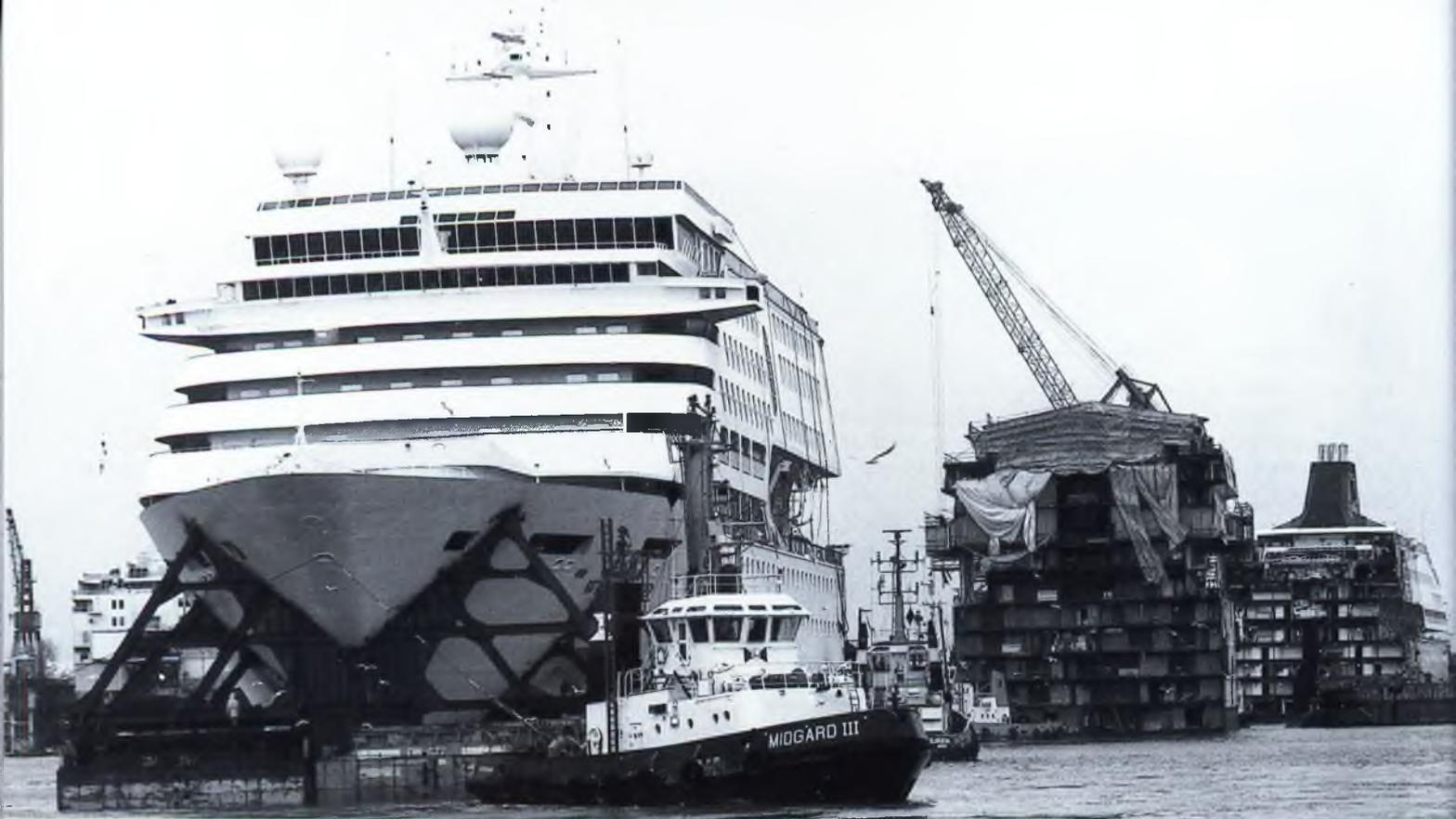
Dieses eindrucksvolle Bild vom Umbau der WINDWARD zur NORWEGIAN WINDS zeigt das Einschwimmen des neuen Mittelteils zwischen die beiden Schiffshälften im Dock der Bremerhavener Lloyd Werft am 24. Januar 1998. Das Vorschiff wird mit einer Haltekonstruktion auf Pontons in stabiler Position gehalten. Foto: Peter Voß
