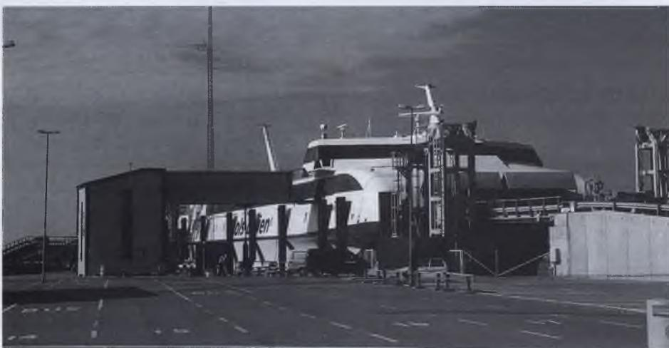
Deutlich ist auf diesem Foto der MIE MOLS die in beiden Häfen identische Rampenkonfiguration zu erkennen, das Schiff wird gleichzeitig über den Bug beladen und über die linke Heckrampe entladen. Foto: Andreas Wörteler
