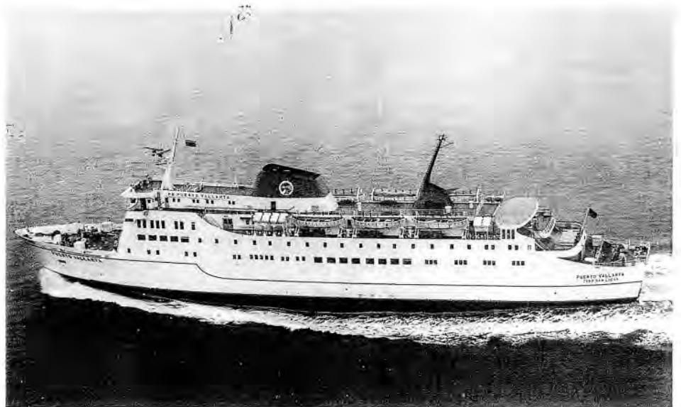
Deutlich zu erkennen sind die zusätzlichen Kabinen durch eine andere Anordnung der Fenster bei der PUERTO VALLARTA. Foto: Sammlung Günter Arp
