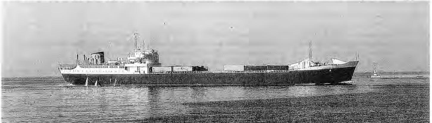
**Mit der ESPRESSO MARILEN stieg die italienische Reederei Traghetti del Mediterraneo S.p.A. in den weltweiten Ro-Ro Verkehr ein. Deutlich zu erkennen ist der ehemals mittschiffs gelegene Brückenaufbau, der beim Umbau zur Frachtfähre vor den Maschinenaufbauten plazierte. Foto : Sammlung Frank Heine**
