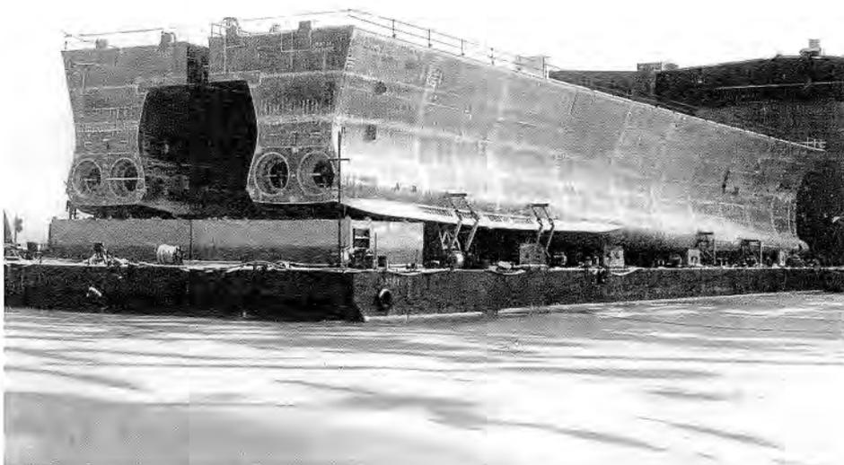
Die Rumpfsktion des erste HSS-Katamarans wurde aus der Bauhalle bei Finnyards in Rauma geschleppt, der Einsatz ist für den 1. Oktober 1995 zwischen Holyhead und Dun Laoghaire geplant. Foto: Finnyards
