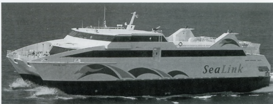
Die SEALION 2000, obwohl ein Katamaran ist kein „High-Speed“-Schiff, die Dienstgeschwindigkeit liegt bei 15 Knoten. Foto: Bauwerft
