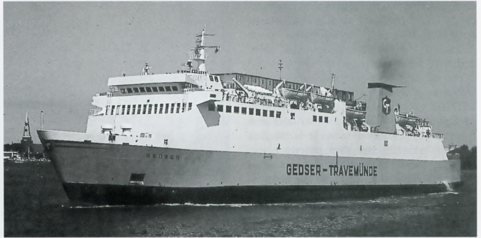
Wohl einmalig in der Geschichte der Fährschiffahrt war der Umbau der GEDSER, ohne dass das Schiff aus der Linienfahrt genommen wurde. Schön zu sehen die vormontierten Container auf dem Oberdeck. Foto: Sammlung Gunnar Menzer
