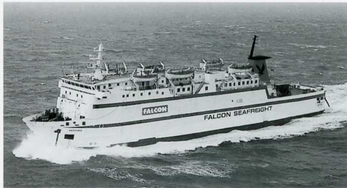
Für ihren Einsatz im Ärmelkanal erhielt die NEPTUNIA die typischen „Kuhfänger“, auf die die Anleger gelegt werden. Foto: Fotoflite
