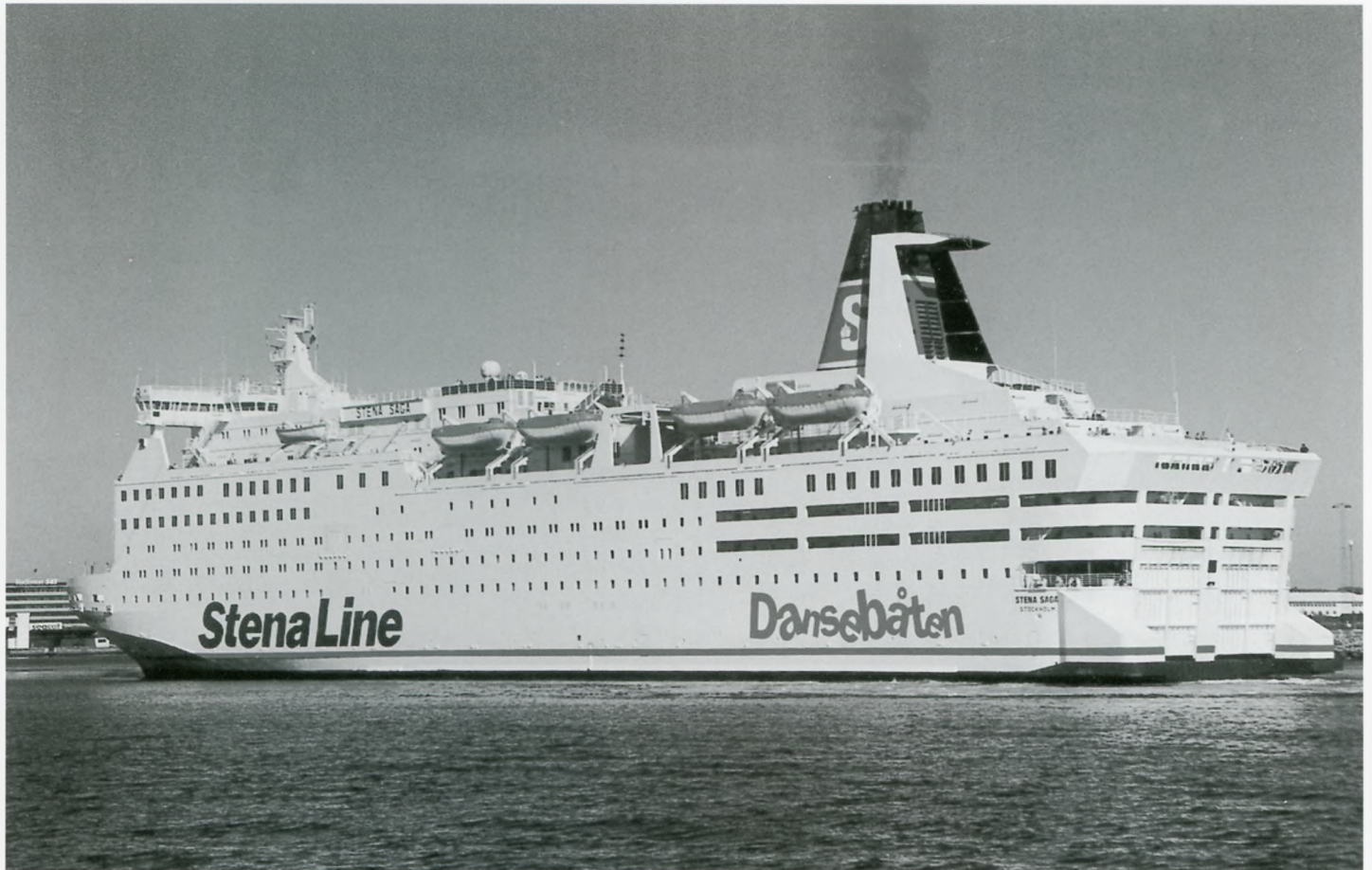
Nachdem Umbau im vergangenen Winter bei der Cityvarvet in Göteborg präsentiert sich die STENA SAGA nun mit zusätzlichen Auftriebstanks am Heck und der poppigen Aufschrift, die wohl hauptsächlich partyfreudige Fahrgäste anlocken soll. Foto: Frank Lose
