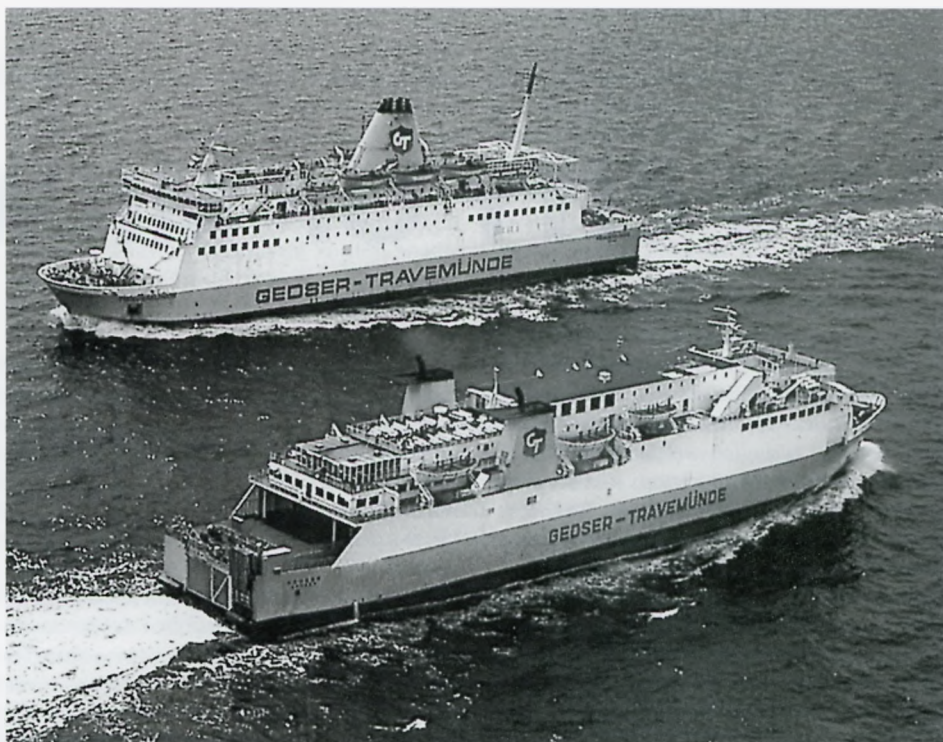
Die neue TRAVEMÜNDE und die GEDSER begegnen sich, deutlich zu erkennen die zusätzlichen Kabinen und die verlängerten Abgaspfosten der GEDSER, die das Schiff bei seinem Umbau 1977 erhielt.
